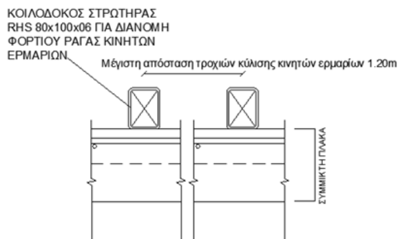
Εικόνα 14: Λεπτομέρεια στρωτήρα κοιλοδοκού στη σύμμικτη πλάκα σε σημεία τοποθέτησης κινητών ερμαρίων. Τομές κατά άξονα και κατά άξονα Υ
